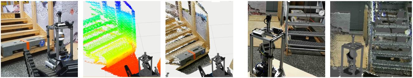
**Abbildung 4** Die kolorierten Lidar-Punktwolken [11] bieten ein verbessertes Situationsbewusstsein für den Roboteroperator.
