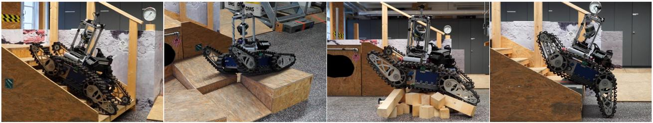
(a) Treppe mit 35 Grad Steigung. (b) Erhöhte angewinkelte Rampen. (c) Ein Geröllhaufen. (d) 32 cm Stufenhöhe.
