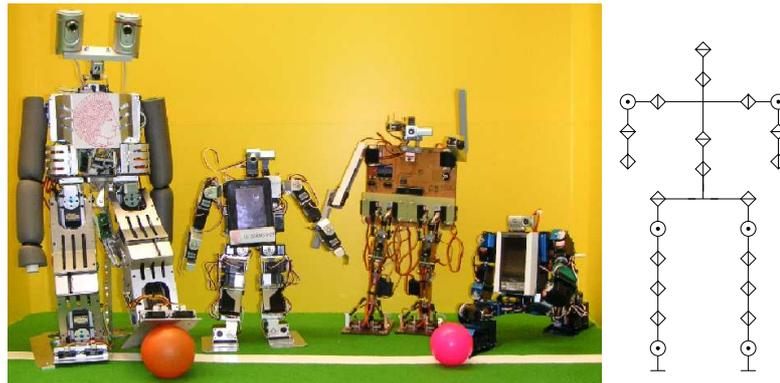
**Abb. 1.** Die vier untersuchten, ca. 37-68 cm großen Humanoid-Roboter-Prototypen (links) und kinematische Struktur von Mr. DD (rechts).
