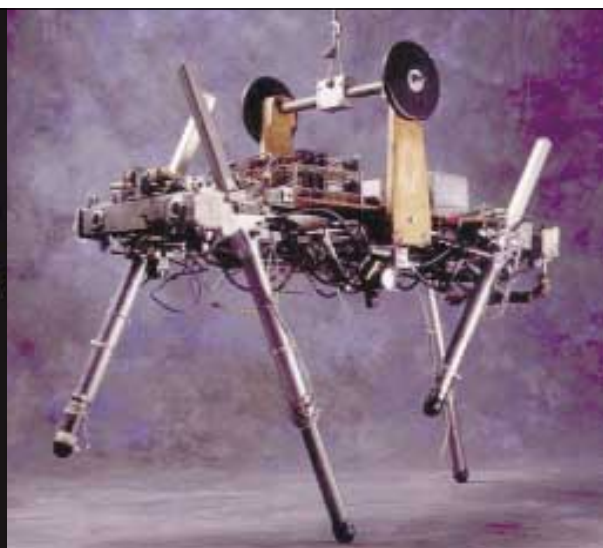
Bild 3: Ein- und vierbeinige Hüpfroboter [6]. One- and four-legged hopping robots [6].
