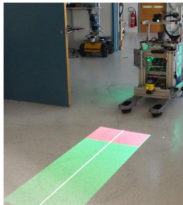
Abbildung 2.12: Optima ML 750 - Mobiler Industrietransportroboter. Ein auf dem Roboter montierter Projektor, visualisiert den Sicherheitsbereich und seine Trajektorie
