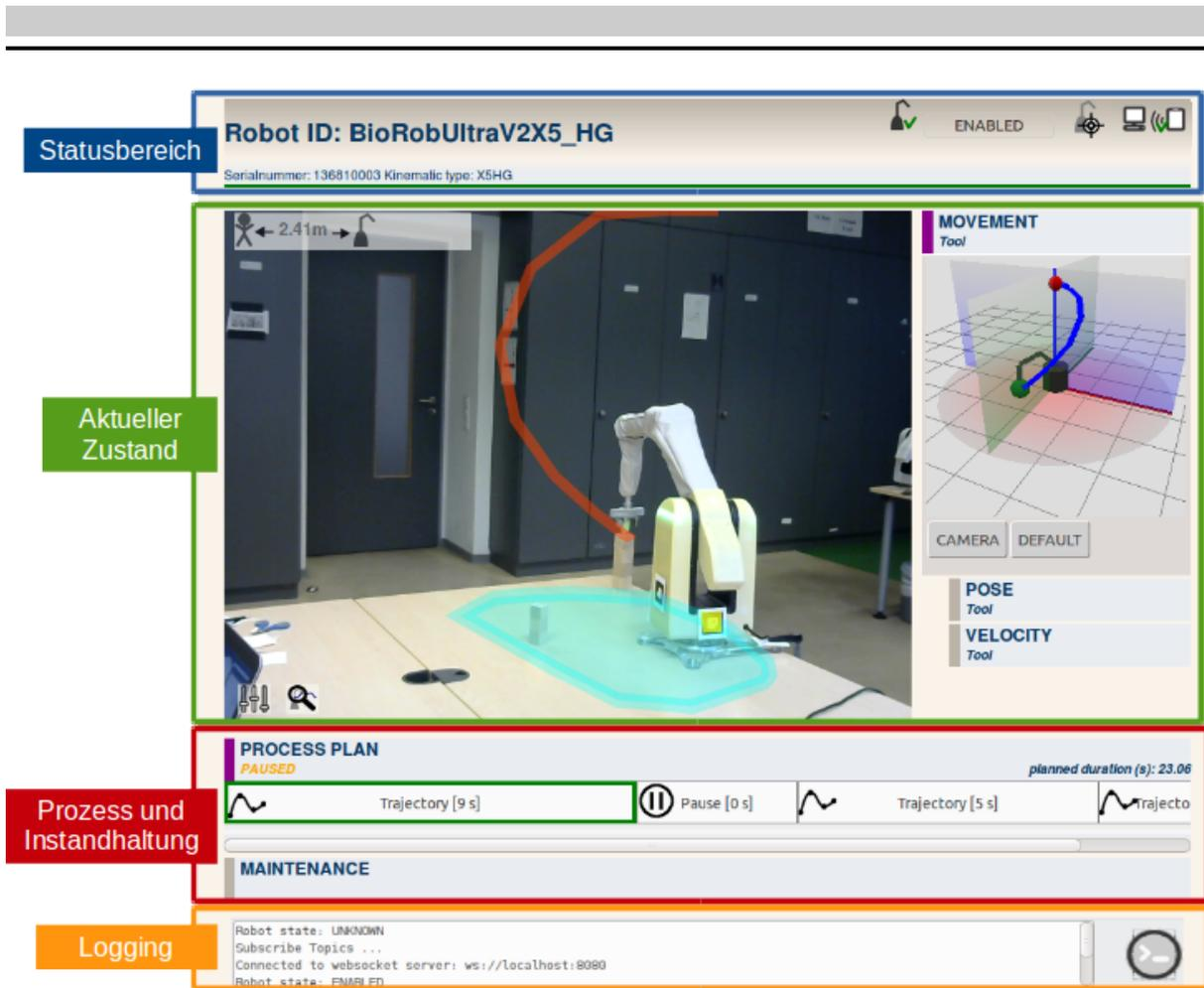
Abbildung 4.4: Umsetzung der graphischen Benutzeroberfläche, welche in vier semantisch zusammenhängende Bereiche aufgeteilt ist: Status, Aktueller Roboterzustand, Prozess und Instandhaltung, sowie Logging
