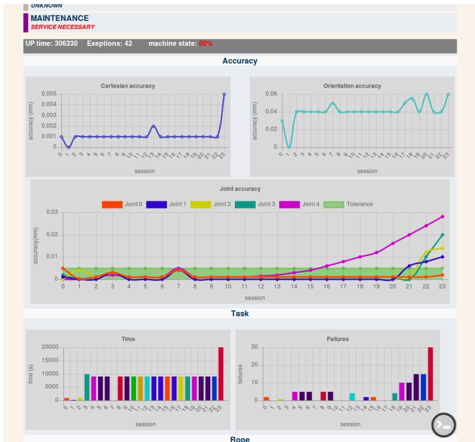
Abbildung 5.9: Visualisierung des BioRob-Arms Zustands. Die Wartungsinformationen werden in Form von Balken und Liniendiagrammen dargestellt.
