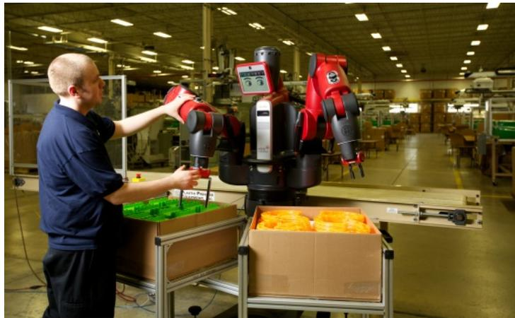
Abbildung 2.10: Baxter - zweiarmiger Roboter mit einem festmontiertem Display. **Quelle:** [2]
