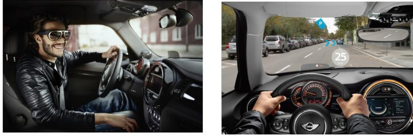
Abbildung 2.4: See Through mit einer Datenbrille (Mini Augmented Vision). Informationen werden direkt ins Sichtfeld eines Autofahrers eingeblendet. **Quelle:** [1]
