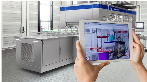
Abbildung 2.3: Registrierung der Objekte. Die reelle Umgebung wird um computergenerierte Inhalte erweitert. Die virtuellen Inhalte werden direkt an der Maschine eingeblendet **Quelle:** [20]
