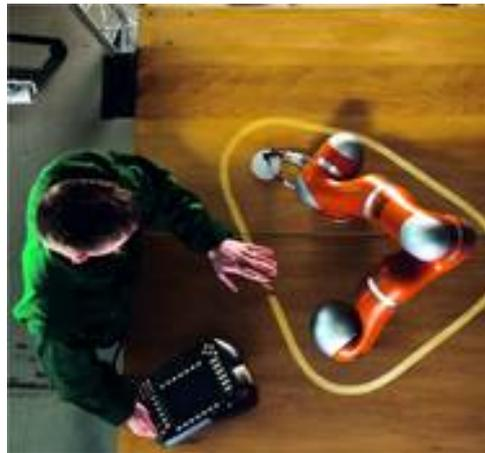
Abbildung 2.9: Arbeitsraumüberwachung. Unterbrechung des Lichtstrahls führt zum Anhalten des Roboters. **Quelle:** [35]
