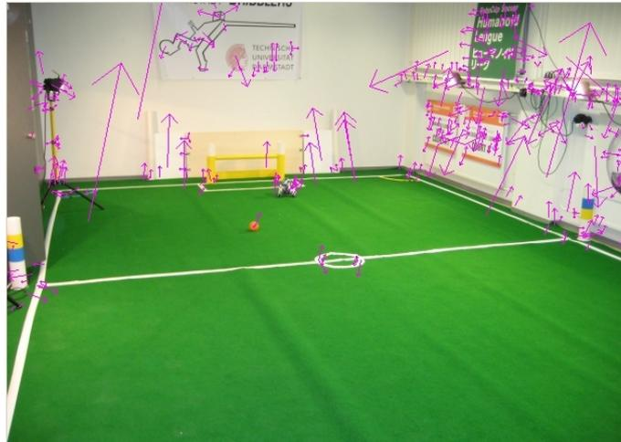
**Abbildung 5.1:** In monotonfarbenen Flächen können nur wenige Merkmale gefunden werden. Merkmale werden mit einem Pfeil dargestellt, dessen Ursprung die Position, die Richtung die Orientierung und die Länge die Skalierung widerspiegelt.
