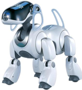
Abbildung 5.1: Foto des SONY®Aibo ERS-7. Man erkennt den Lautsprecher in der Brust sowie das Mikrofon am linken Ohr. Copyright SONY®.
