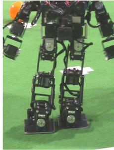
Abbildung 5.9: Rahmenteile der Beine eines Roboters
