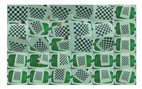
Abbildung A.4: Schachbrettmuster zur Kalibrierung der intrinsischen Parameter
