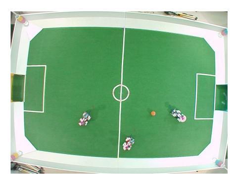
Abbildung 4.1: Verzerrtes Kamerabild
