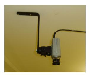
Abbildung A.1: Kamera mit Montagewinkel zur Befestigung an der Decke
