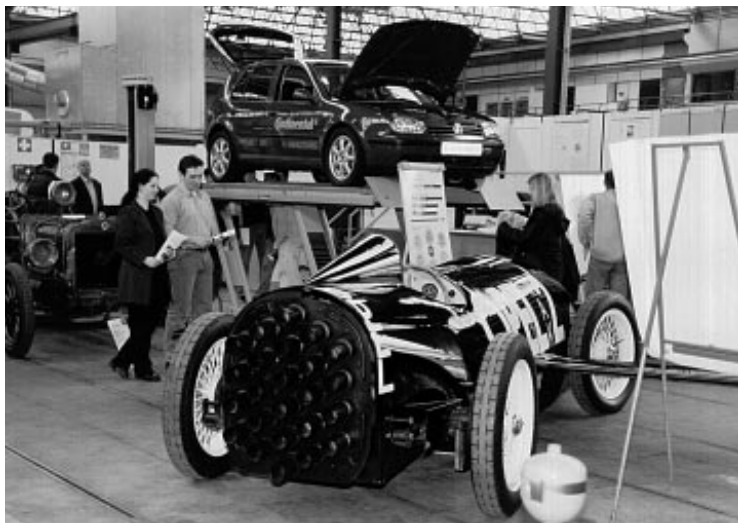
RAK 2, der legendäre raketentriebene Rennwagen Fritz von Opels aus den 20er Jahren, gehörte zweifellos zu den Highlights des High-Tech-Open. Dabei ging's nicht nur um den maßstabsgerechten Nachbau, sondern auch um das studentische Projekt, den RAK 2 virtuell mit Hilfe des 3D-CAD-Systems Unigraphics auf dem Bildschirm zu rekonstruieren. Eine Aufgabe aus dem Fachgebiet Datenverarbeitung in der Konstruktion, die das fünfköpfige Team erfolgreich gelöst hat.
