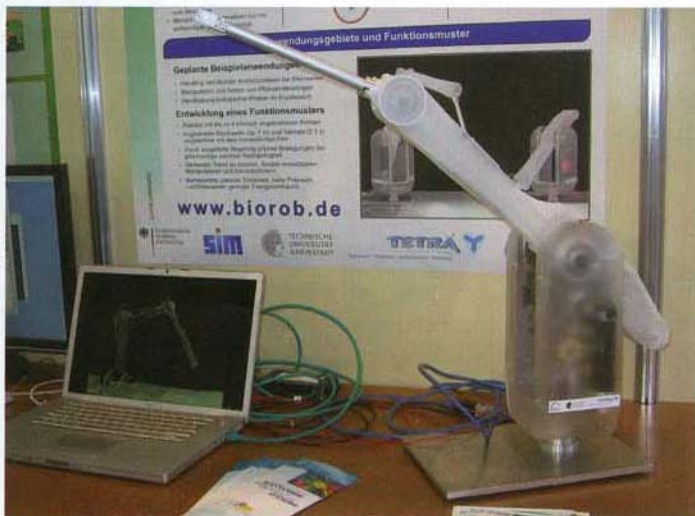
De BioRob is lichter, inherent veiliger en verbruikt minder energie dan een conventionele robot met vergelijkbare prestaties (foto: Ad Spijkers)
