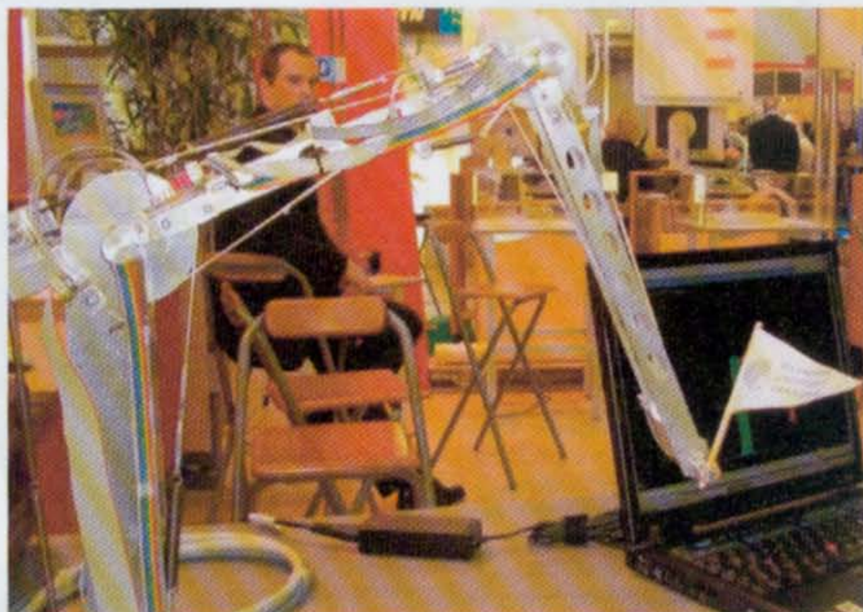
Der bionische Manipulator wird in drei Hauptachsen elastisch angetrieben. Beidseitig verspannte Federn übernehmen die elastische Funktion von Sehnen und Muskeln.
